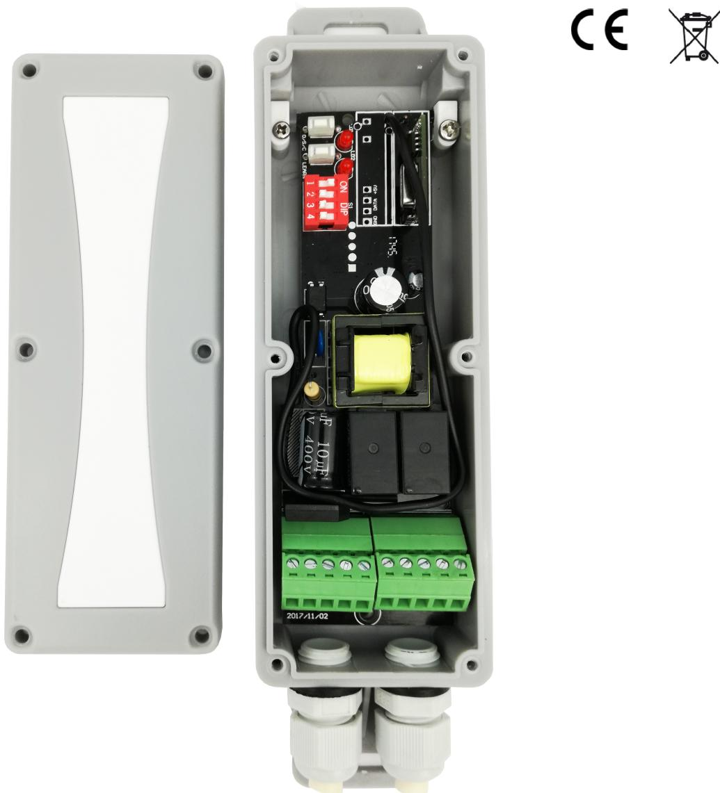
Cuadro de control monofásico de 100 a 250 V AC para persianas enrollables, con receptor multimarca Rx Multi integrado para frecuencia 433 MHz. Entradas de pulsador arriba/abajo configurables como "hombre presente", orden directa o pulsador secuencial. Con cierre automático disponible y entrada de fotocélula.
