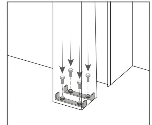
**04** • Fije las guías laterales en las chapas de soporte del cofre con tornillos y anillas, apretándolos en las tuercas que se encuentran en las guías.
