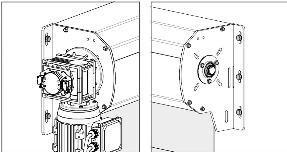
**03** • Haga los agujeros en los puntos marcados, y después aplique el cofre en la pared fijándolo con los tacos y tornillos.
