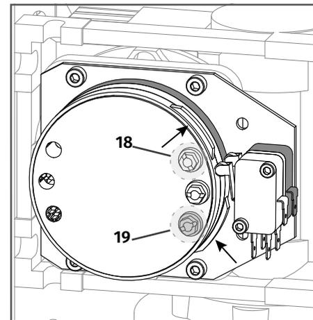
**NOTA** • El anillo rojo debe activar el micro-switch por debajo, y el anillo blanco debe activar el micro-switch por encima, como se ve en la imagen de la izquierda.
