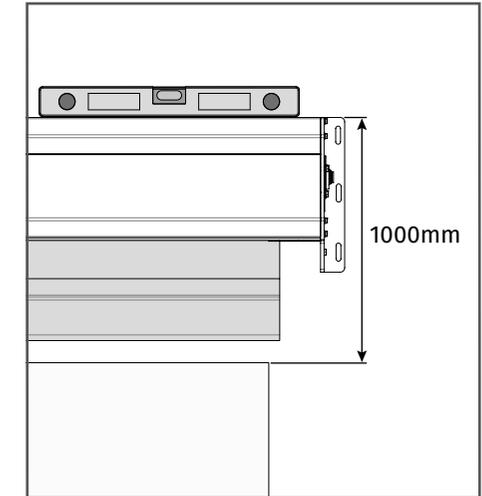
**01** • Aplique el cofre en la pared, centrado en el hueco de luz. ajuste la dimensión del cofre teniendo en cuenta la dimensión indicada en la imagen y el nivel horizontal (use un nivel).
